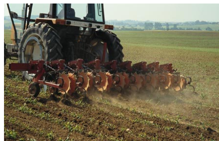
Le buttage des tournesols par les disques permet de recouvrir les adventices sur le rang (effet herbicide).
