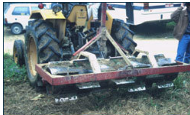
Lámina 20. Rodillo de cuchillas montado en un tractor. (T. Friedrich).
