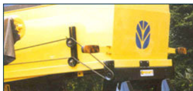
Lámina 27. Desparramador de paja en una cosechadora. (MAX - Irmãos Thonnigs Ltda.).
