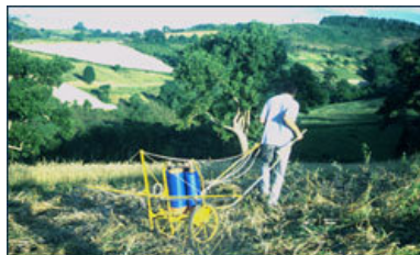
Lámina 30. Una pulverizadora de mochila adaptada a la tracción humana. (T. Friedrich).
