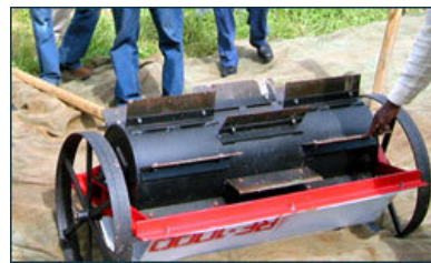
Lámina 14. Rodillo de cuchillas para tracción animal en posición de transporte. (T. Friedrich).
