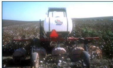
Lámina 34. Pulverizadora con protecciones para la aplicación de herbicida en cultivos en surcos. (T. Friedrich).
