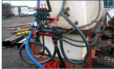
Lámina 36. Pulverizadora antigua ajustada con una bomba nueva, controles y líneas de pulverización. (T. Friedrich).
