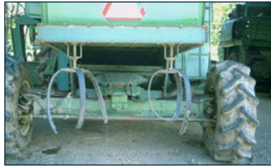
Lámina 28. Desparramador de paja construido por un agricultor. (T. Friedrich).
