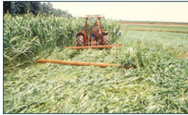
Lámina 23. Tubos de metal detrás de un tractor usados como un aplastador de cultivos de cobertura.
