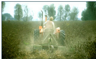
Lámina 24. Cortadora en un tractor usada para cortar residuos de algodón. (T. Friedrich).
