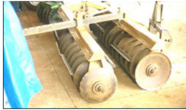
Lámina 22. Rastra de discos modificada para ser usada como rodillo de cuchillas. (T. Friedrich).
