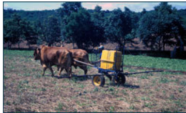
Lámina 33. Pulverizadora con aguilón, de tracción animal. (T. Friedrich).
