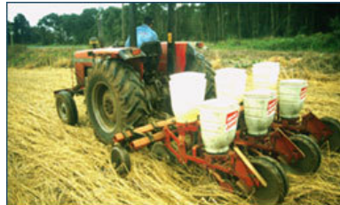
Una sembradora de tres hileras sembrando por un cultivo de cobertura acamado por un rodillo de cuchillas. (T. Friedrich)
